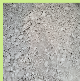
Béton concassé, prêt à être réutilisé
