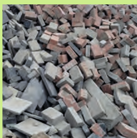
Béton et lots défectueux sont transformés et réutilisés comme matériaux de soubassement pour la construction routière.
