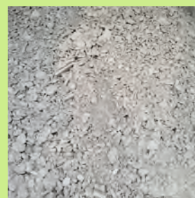
Béton concassé, prêt à être réutilisé
