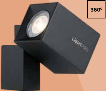
Quartz (196W) Aluminium - Noir LED 1,8 W 3.000 K 150 lm 105 x 50 x 88 mm (H x L x P) - Peut également être utilisée comme applique murale.
