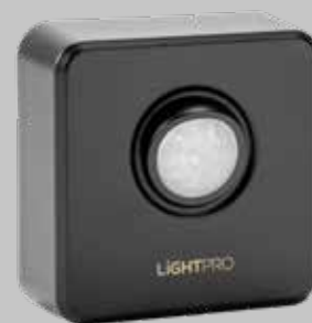
Détecteur de mouvement Smart (Zigbee) (227A) Plastique - Noir Portée de détection jusqu'à 10 mètres Angle de détection 120 degrés Comprend 2 piles AAA 70 x 70 x 32 mm (H x L x P)
