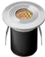
Onyx 30 RS (240D) Inox 316 LED 0,5 W 2.700 K 4 lm 59 x 45 mm (H x Ø) Trou de forage 30 mm
